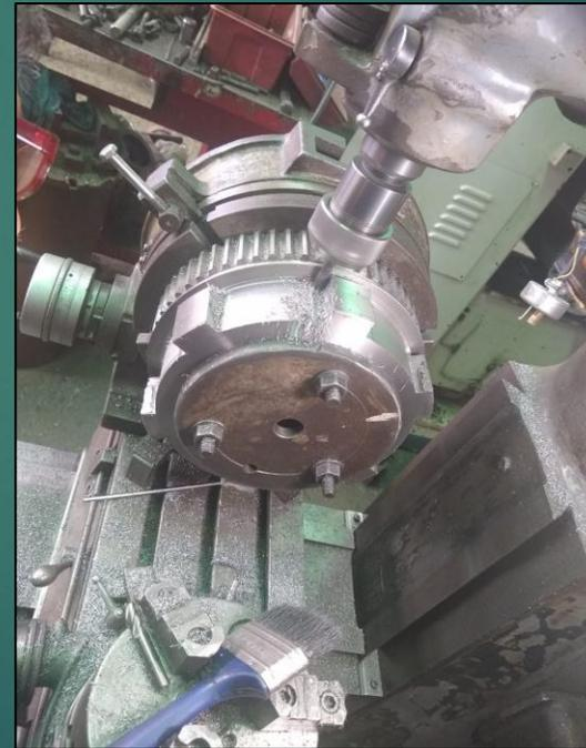
Tumbar engrane desgastado de pieza original y fabricar caja dentada.
